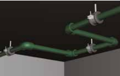
B) Liras de dilatação, formadas por 4 curvas a 90°, funcionam como um duplo braço deslizante. O comprimento da lira (LC) deve ser pelo menos 10 vezes o diâmetro do tubo. Já o comprimento do braço deslizante (Lg) se calcula pela fórmula anterior.
