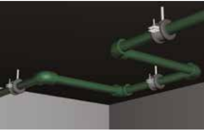
B) Liras de dilatação, formadas por 4 curvas a 90°, funcionam como um duplo braço deslizante. O comprimento da lira (LC) deve ser pelo menos 10 vezes o diâmetro do tubo. Já o comprimento do braço deslizante (L B ) se calcula pela fórmula anterior.
