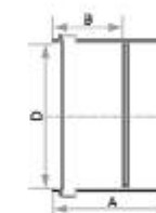
Luva Simples Esgoto SN
