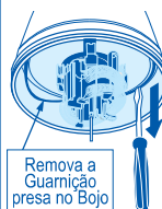
Figura 1: Retirada da Guarnição presa no Bojo.
